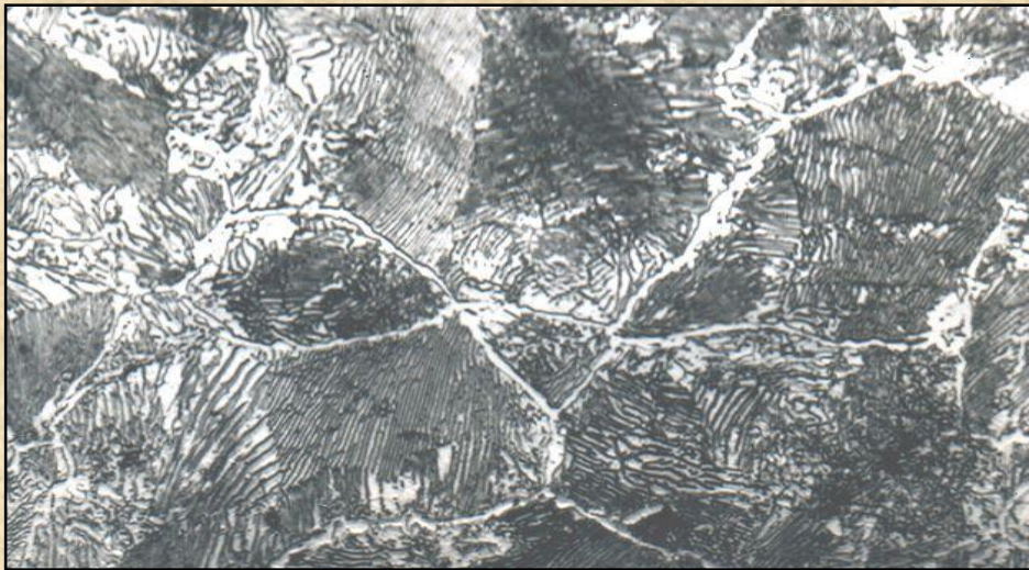
Ciemne ziarna perlitu, jasny cementyt wtórny na granicach ziarn.
