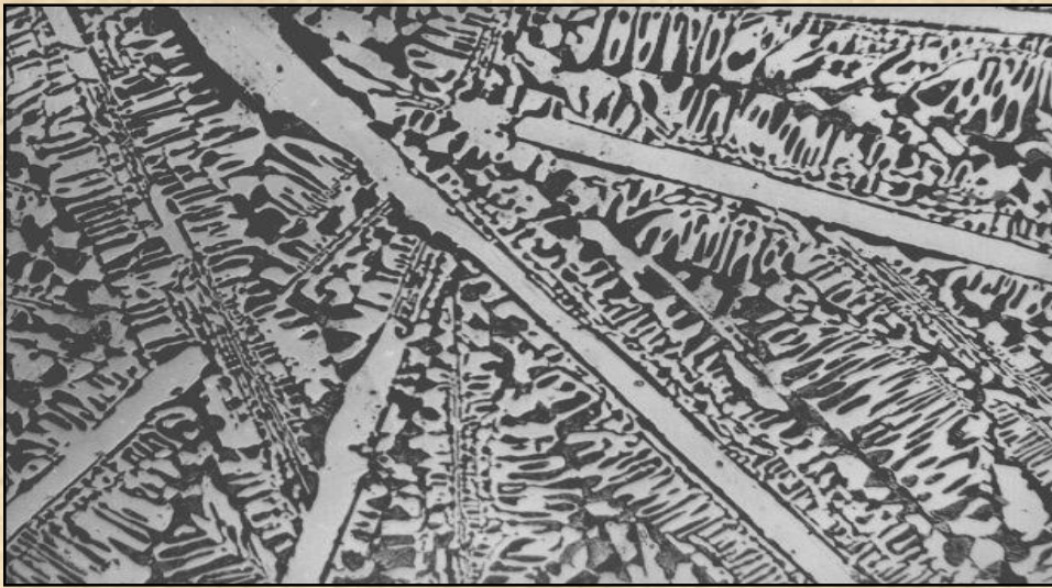
Długie wydzielienia cementytu pierwotnego na tle ledeburytu przemiennego.
