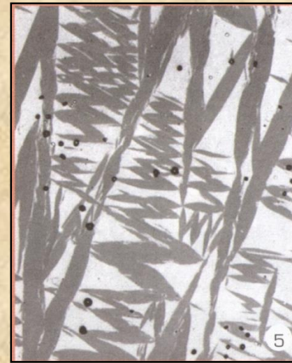
Struktura martenzytu płytkowego, pow. 200 x, m.o.
